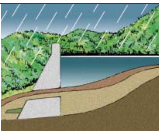
⑤排砂ゲート(土砂フラッシュ)
