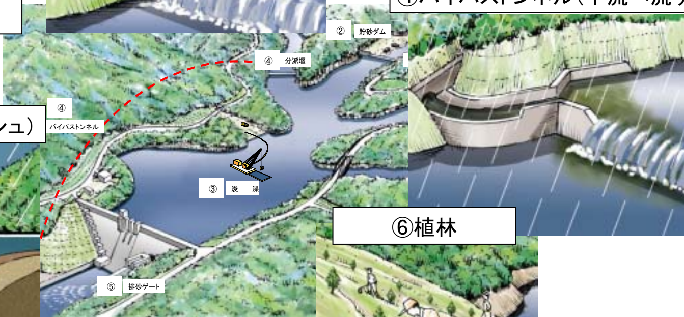
④バイパストンネル(下流へ流す)
