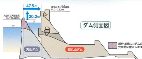
ダムのかさ上げによる 治水機能の強化と水力発電の増強
