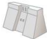
重力式 コンクリートダム
