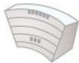
アーチ式 コンクリートダム
