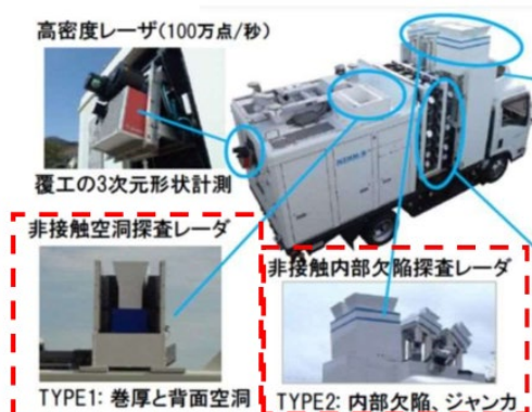
他分野新技術 （走行型トンネル点検）
