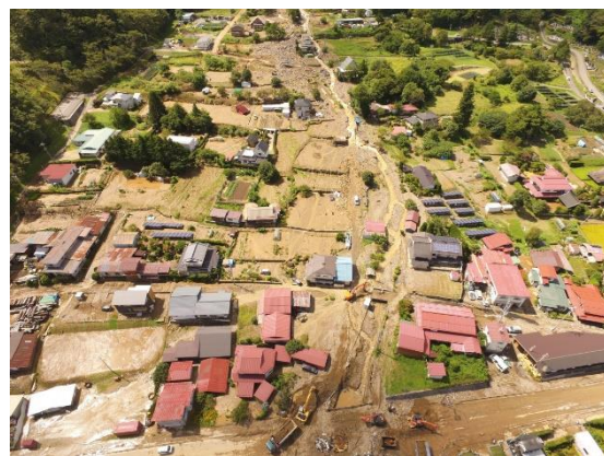
山地流域で発生した土砂の 下流河川における堆積と氾濫 (長野県茅野市)
