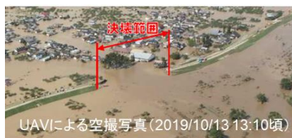
図-2 越水による決壊(千曲川)
