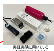
実証実験に用いている6種類の浸水センサ ワンコイン浸水センサの設置(イメージ)
