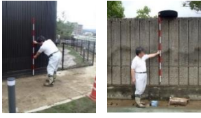
技術者が洪水痕跡を現地で調査
