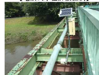
【超音波式水位計設置例2】
