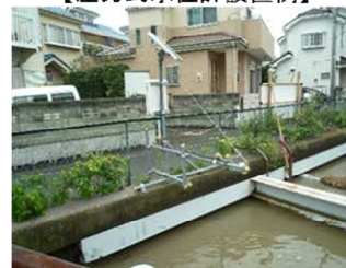
【超音波式水位計設置例1】
