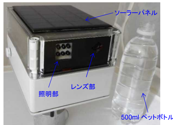
設置イメージ (ハウジング・装柱時)
