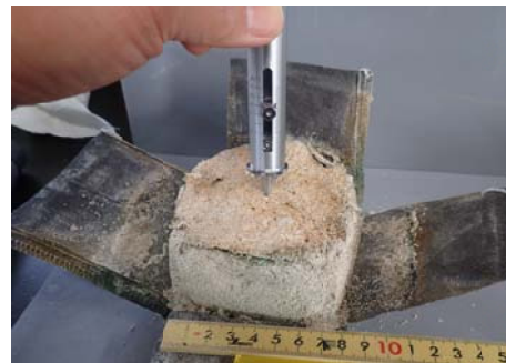
図-14 固化試験体と強度計測の例
