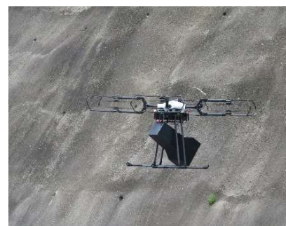
図-1 吹付法面非接触地中レーダ探査
