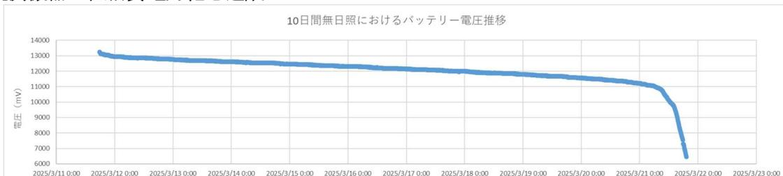
最新の観測機を15°C~20°Cの外気温環境に放置し、充電せずに設計上の動作・伝送間隔で連続稼働試験を行った。ほぼ新品12V 5Ah(60Wh)鉛蓄電池(標準的なもの)を使用し、満充電からバッテリー
