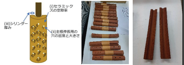
写真-5 試作したセラミックスシリンダーと発根時のイメージ
