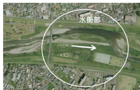
図 27 昭和橋下流の右岸砂州における掘削路
