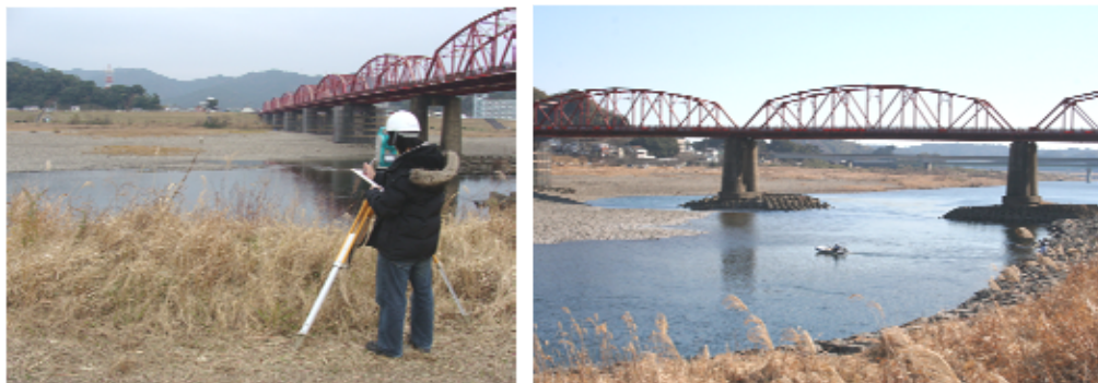
図-10 トータルステーションによる砂州形状測量・魚群探知機による河床形状計測状況
