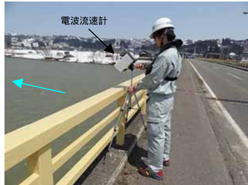
写真-1 可搬タイプの電波流速計による観測の様子
