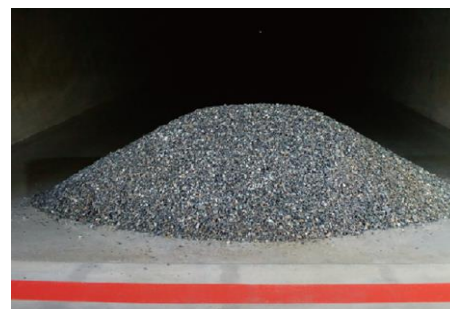
図-3 トンネル内の置き土実験
