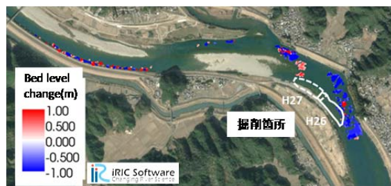
(a) 出水前後の河床変動量(実測結果)
