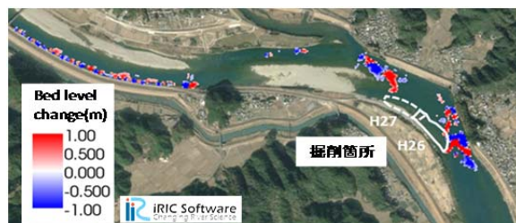
(b) 出水前後の河床変動量(解析結果)
