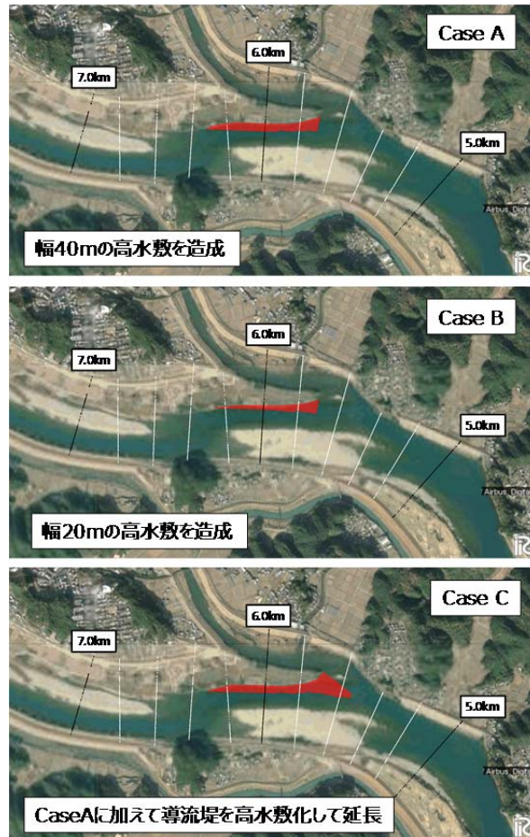
図-10 現況河道から合流部の導流堤の平面形改修案（赤の範囲を高水敷として造成する場合）
