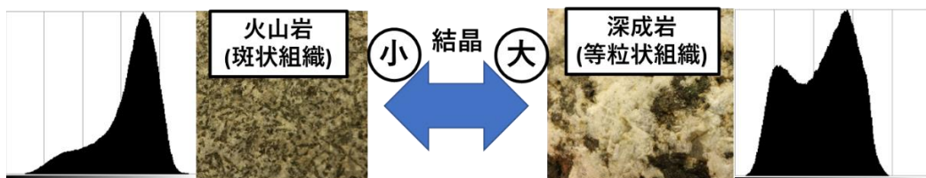
図-8 河川礫の画像分析方法(フリーソフト: GIMP for Windowsによる画像全体の明度)
