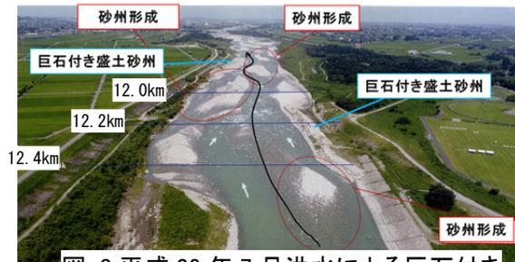
図-3 平成 29 年 7 月洪水による巨石付き盛土砂州周辺の瀬淵の形成
