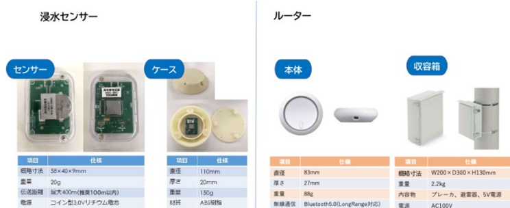
図 2 BT5方式浸水センサーのフィールド設置のためのハウジング等検討
