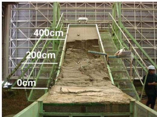
図-21 崩壊後の模型斜面（正面）
