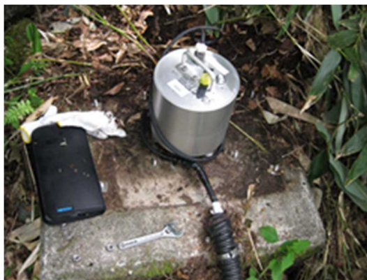
Plate.1 : 松本砂防事務所上高地防災情報センター敷地東端の既存の地震計台（上）と今回設置した地震計（下）.
