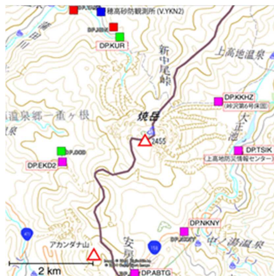
Fig.1：焼岳火山周辺の振動（地震）観測点の分布。■は京都大学、■は神通川水系砂防事務所、■は気象庁の、それぞれオンライン観測点。■は京都大学のオフライン観測点であり、このうち、DP.KKHZとDP.TSIKの2点を、本研究開発でオンライン点に転換した。また、DP.KKHZには、気泡型傾斜計を併設した。
