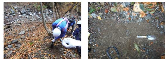
写真-1 試料採取状況 (a) 採取位置の概況 (b) 採土円筒による採取
