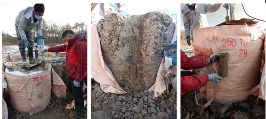
写真-1 供試体コア採取状況
