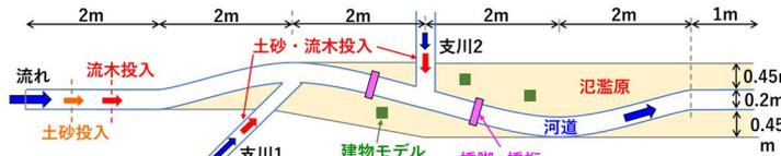
図-6 実験施設の概要 (基礎実験 2)
