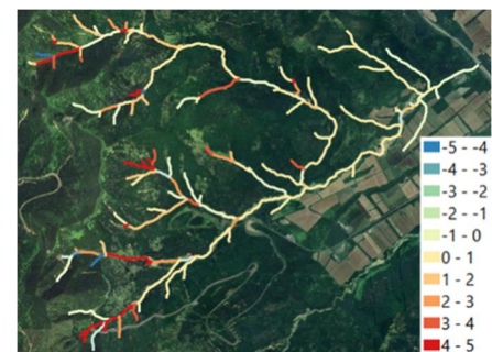
図-10 風化を考慮したことによる河床高の変化(m)
