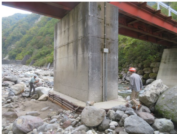
図6 常願寺川妙寿砂防堰堤下流の橋脚（上）に設置したTDRセンサー（下）。TDRセンサーは保護用金属格子の内部に設置した。
