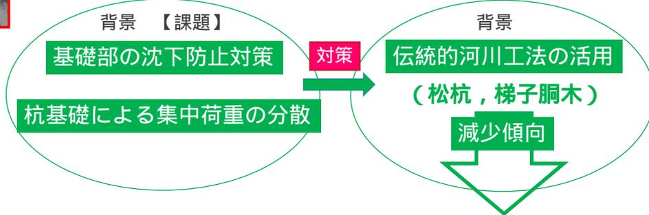
基準書や施工事例, 梯子胴木(松材)の特徴を整理し, **梯子胴木+松杭基礎**の採用を決定!
