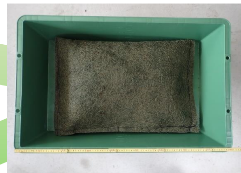
②栽培基盤の準備 ・ヤシ繊維マットを袋状に加工し浮き防止のための鉄筋を挿入し、培養土を重鎮
