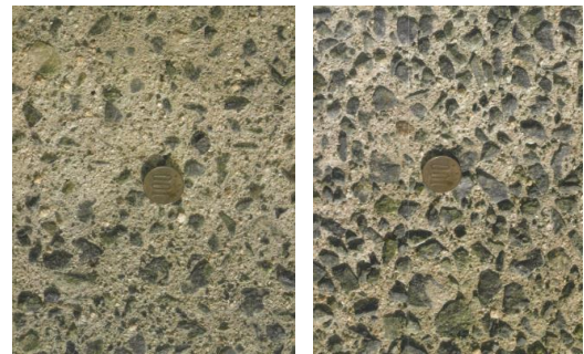
写真5 コンクリートサンプルの比較 (左:通常 右:骨材料多め)
