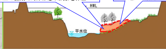
河道掘削 (多自然川づくり)
