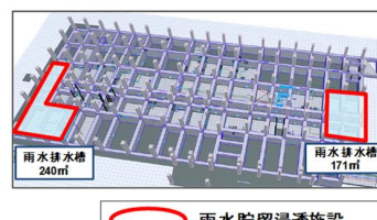
雨水貯留浸透施設
