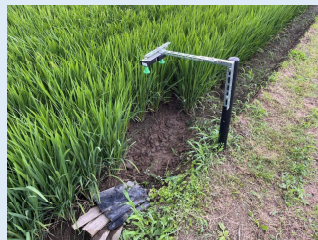
R6年度 流域治水オフィシャルサポーター 国権堀土地改良区様とのコラボ 田んぼでの水位センサの有効性に関する実証
