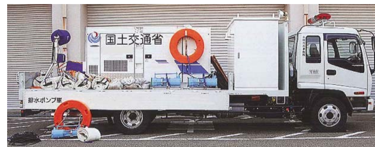
【排水ポンプ車】
