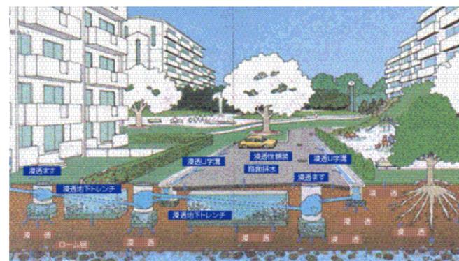
都市化によって、地表がアスファルトやコンクリートで覆われ地面が水を吸収しにくく、保水能力が低下しています。浸透すずりなど浸透施設を設置することによって雨水は地中に浸透。その結果、河川への流出総量が減少、ピーク流量が減少などの保水効果生まれ、河川への負担が軽減します。
