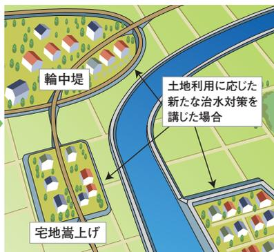
輪中堤や宅地高上げを効率的に短期間で実施することにより、家屋の浸水被害を解消
