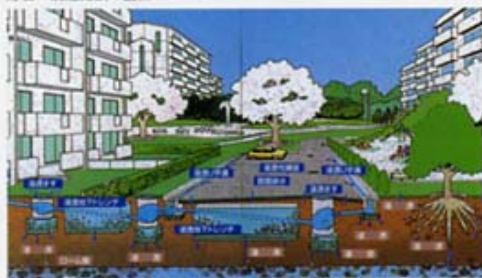
貯留・浸透施設の整備イメージ
