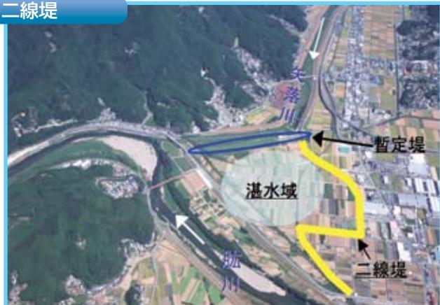
万一、本堤が決壊した場合に、被害を最小限にとどめる為、堤内地に築造される堤防。
