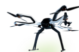
全天候型ドローンの例 風速20m/s程度の強風下で飛行可能
