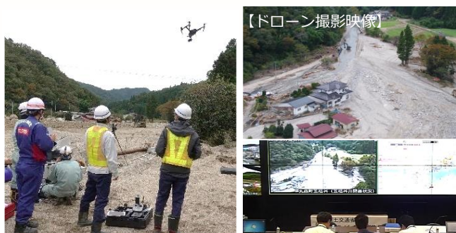
ドローンを活用した被災状況調査と衛星回線を用いたリアルタイム映像配信（宮城県丸森町）
