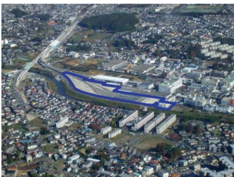
地下鉄車両基地の地下を遊水地として利用
