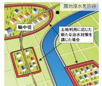
輪中堤や宅地嵩上げを効率的に短期間で実施することにより、家屋の浸水被害を解消します。
