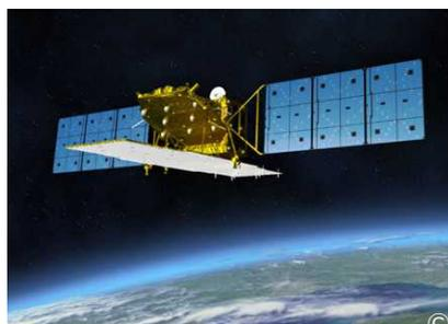
衛星に搭載したSARからの、1度のレーダ照射により、浸水域を広域的に観測します。
