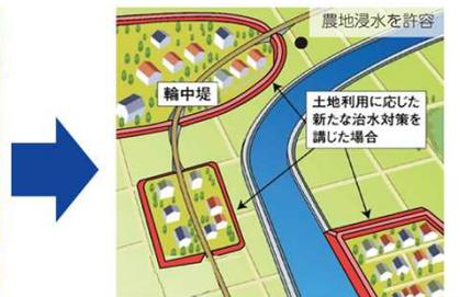
輪中堤や宅地嵩上げを効率的に短期間で実施することにより、家屋の浸水被害を解消します。
