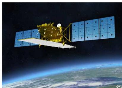
衛星に搭載したSARからの、1度のレーダ照射により、浸水域を広域的に観測します。
