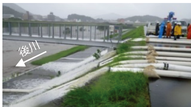
渡川水系後川排水ポンプ車排水状況 (高知県四万十市古津賀)
