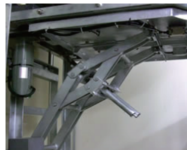
換気口浸水防止機
