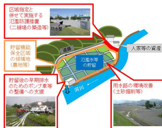
区域指定と併せて実施する二線堤の築造や土地所有者の負担軽減の観点からの制度(イメージ)
