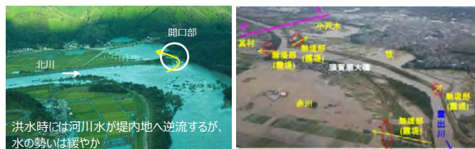
霞堤後背地での貯留(左:五ヶ瀬川水系、右:雲出川水系)
