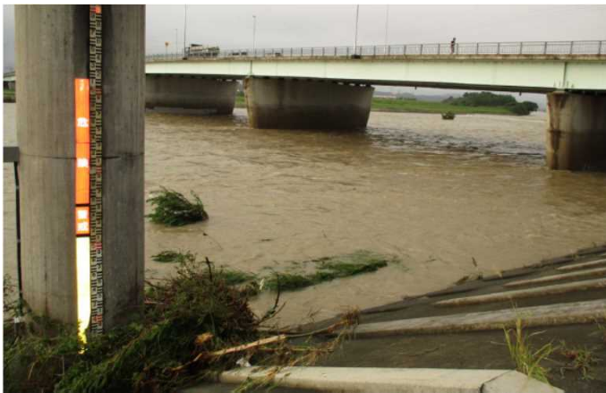
櫛田川左岸7.8km付近櫛田橋水位観測所
