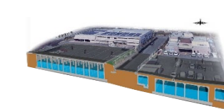
駐車場地下を利用した雨水貯留浸透施設整備【大和川水系】
