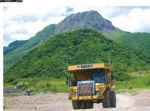
右図：無人化施工重機
