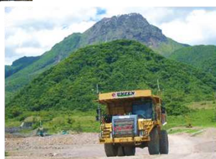
右図：無人化施工重機
