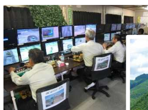
左図：無人化施工操作室
